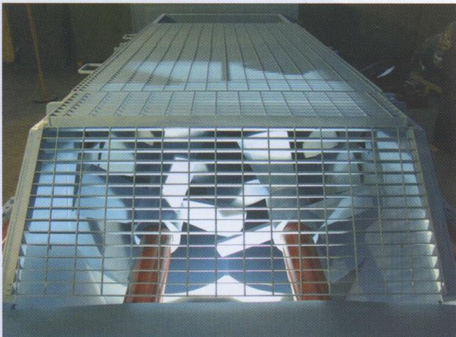
Pale realizzate in acciaio elettrosaldato con possibilità di riporti antiusura e cromatura a doppio spessore, oppure dotati di bordi intercambiabili.
